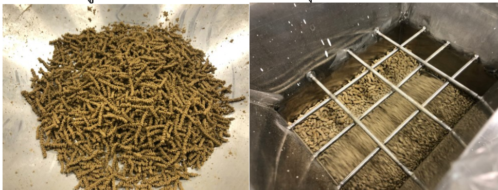
ภาพที่ ๙ การเตรียมแกรนูลเปียกเพื่อใช้ในการผลิตยาเม็ดแกนสูบไซยาซีน
